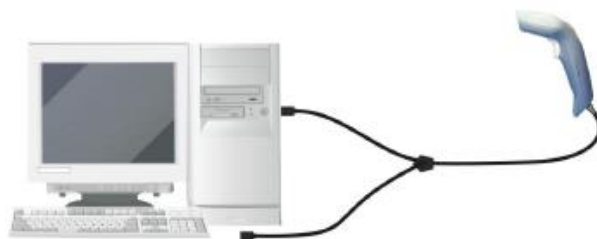
Slika 1: Priključitev čitalnika na osebni računalnik
