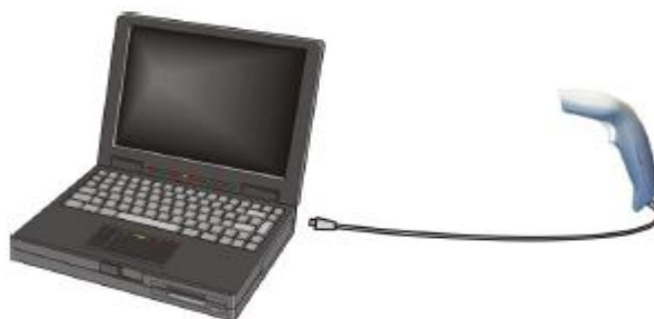
Slika 2: Priključitev čitalnika na notesnik
